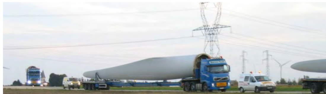
Figure 119 : Illustration du transport des pales (©ATER Environnement)
